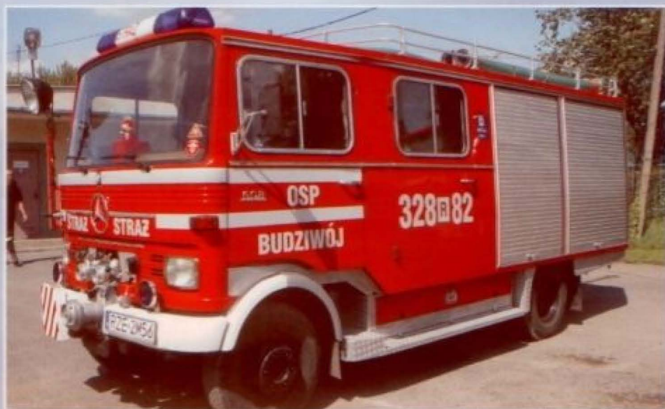
Samochód pożarniczy DAIMLER BENZ 6080 (1974) ze zbiornikiem na wodę, wyposażony w autopompę i motopompę
