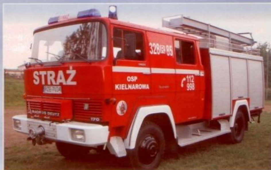
Samochód pożarniczy MAGIRUS DEUTZ FM 170 (1981), ze zbiornikiem na wodę, wyposażony w autopompę i motopompę
