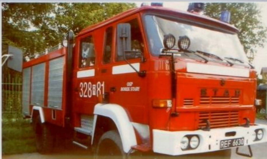
OSP Borek Stary dysponuje samochodem pożarniczym STAR 244 wyposażonym w zbiornik na wodę, autopompę i motopompę
