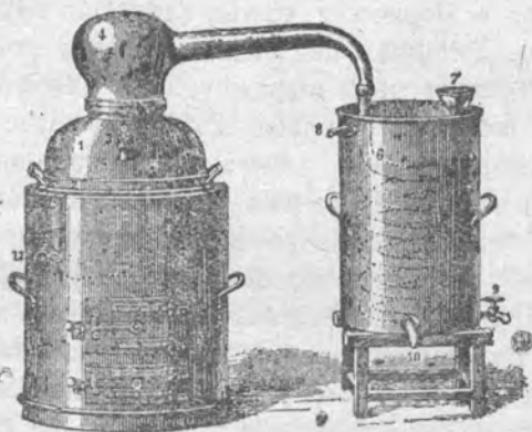
Ryc. 16. Przenośny aparat destylacyjny, prostszej budowy.
