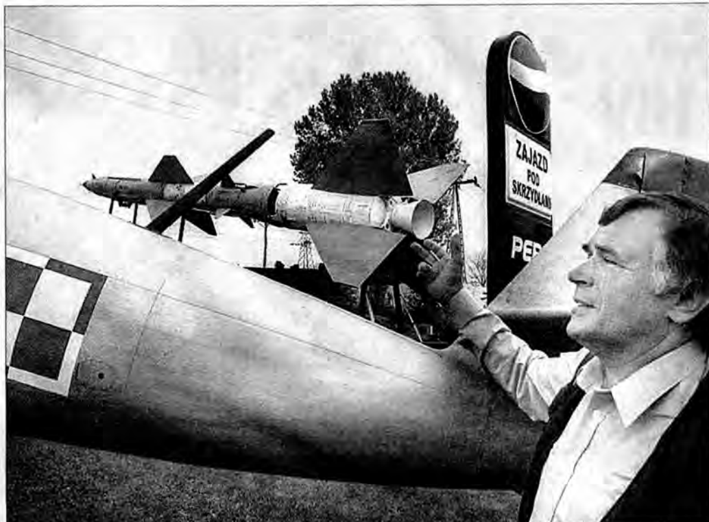
Dwucielonowe rakiety przeciwlotnicze F-75M „Wolchow” przeznaczone są do niszczenia celów na dużych wysokościach. Można je również wykorzystywać do zatapiania statków. Zasięg minimalny pocisku wynosi 7 km, maksymalny – 43 km, prędkość przelotowa ok. 1100 m/s.
