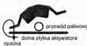
Sposób montażu aktywatora magnetycznego na przewodzie paliwowym.
