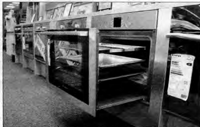
Zaawansowane piekarniki mają wysuwany wózek, dzięki czemu nie musimy wkładać rąk do gorącego piekarnika, aby mieć dostęp do potrawy.
