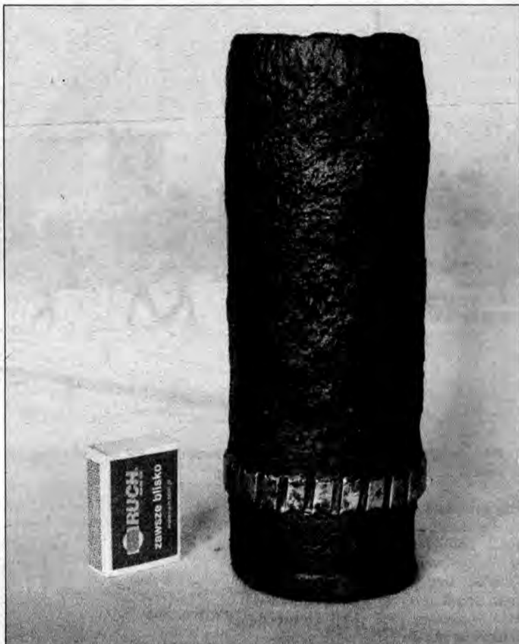
Pusta skorupa pocisku artyleryjskiego, tzw. szrapnela kalibru 8 cm z czasów pierwszej wojny.
