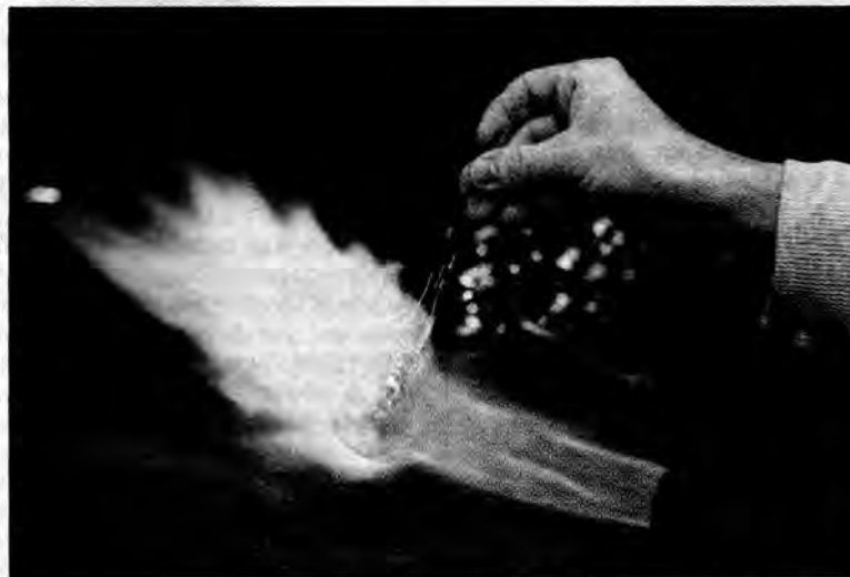
Szkło sodowe po ogrzaniu do temperatury 1500 °C – 2000 °C staje się bardzo plastyczne.
